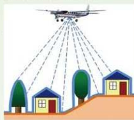
航空レーザ測量
