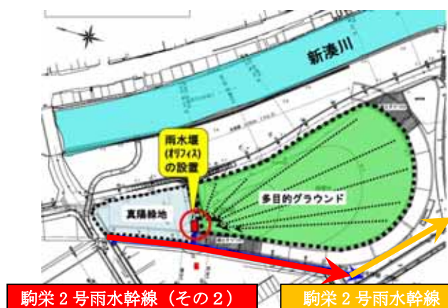
図 2.5.2 真陽南さくらグラウンドにおける流出調整機能施設（オリフィス）の整備予定箇所
