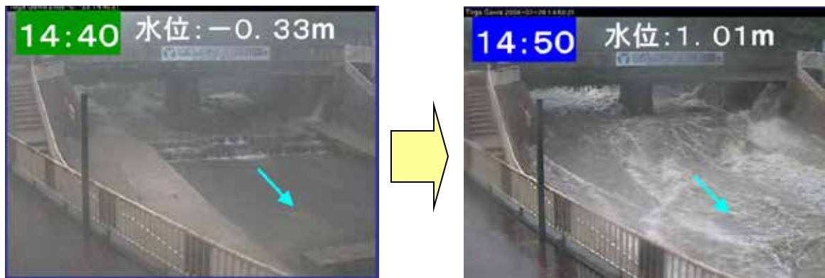
都賀川甲橋水位上昇状況（神戸市モニタリングカメラ画像）
