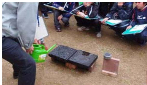
透水性舗装の違いを模型で実験
