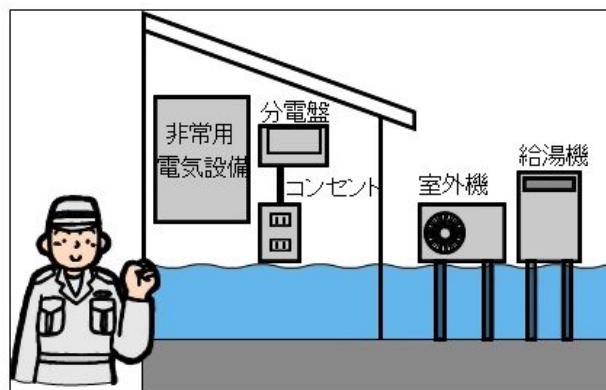
図 7.4.1 電気設備の浸水対策
