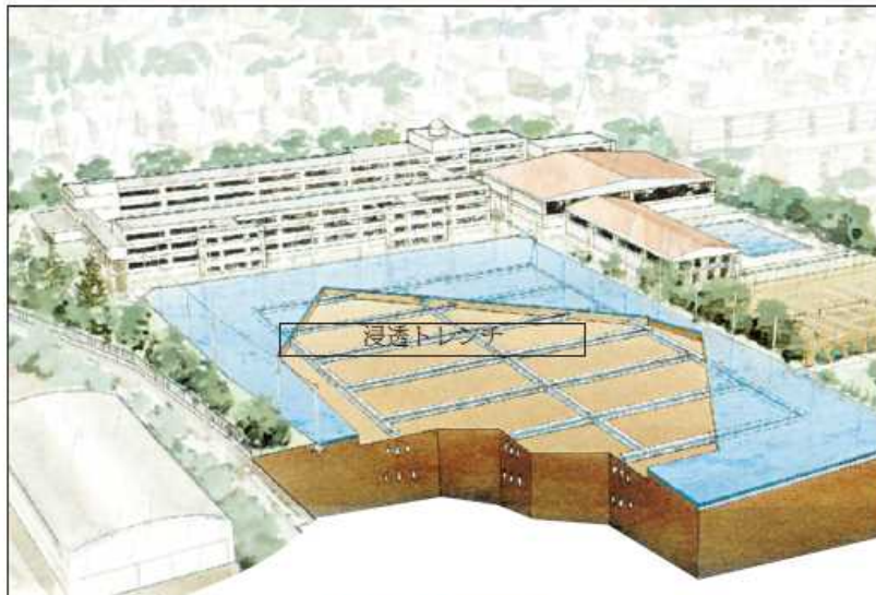
図 6.2.4 学校での浸透施設例（千葉県舟橋市）
