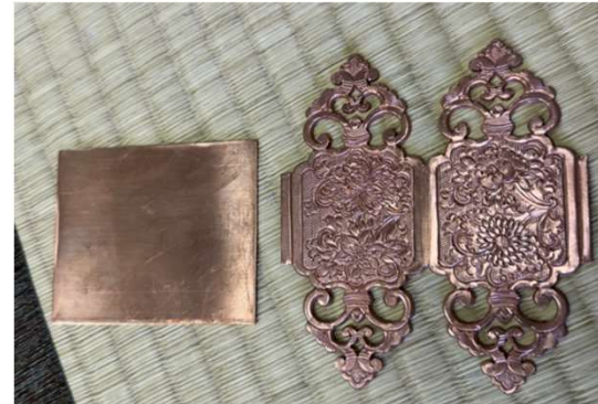
▲金具打ちで模様が刻印された銅板
