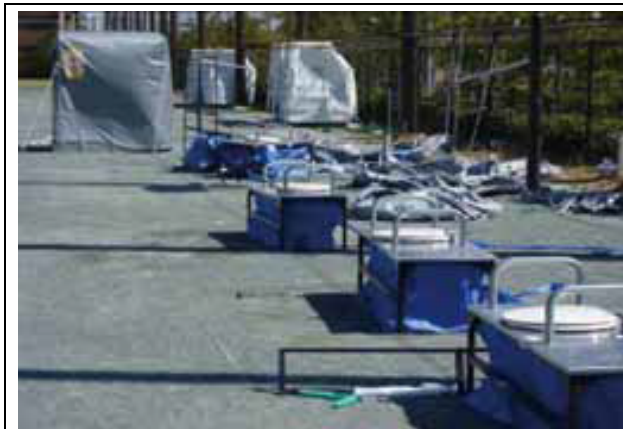
強風で壊れた組立トイレ（浦安市）*2
