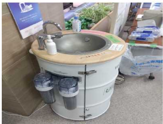
水循環型手洗いスタンド（志賀町）
