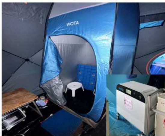
循環型シャワーシステム
