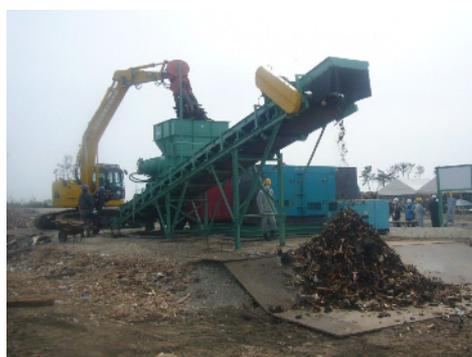
ガレキ置き場に設置した破碎機
