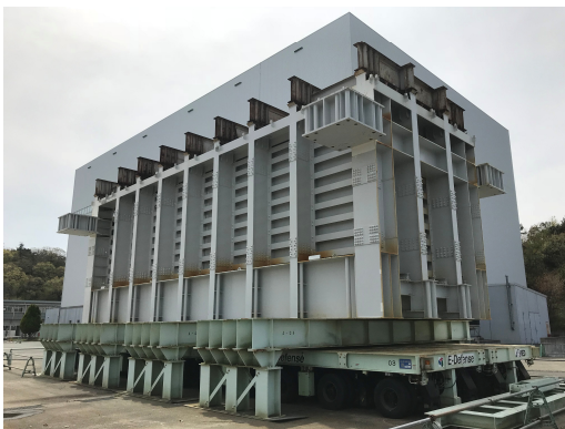
図1 鋼製土槽の外観 ※土槽内寸：W16m×D4m×H4.5m
