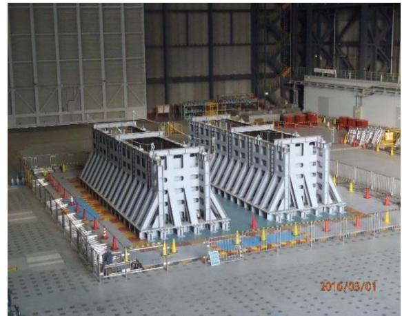
写真7 土槽設置状況 17)
