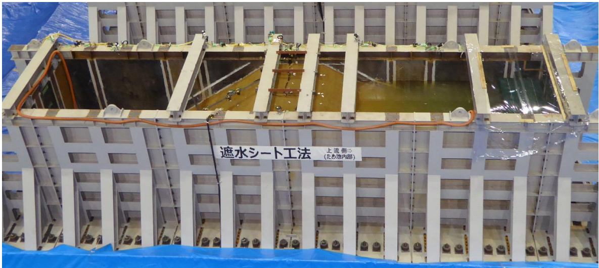
写真 堤体上流部に注水後の状況
