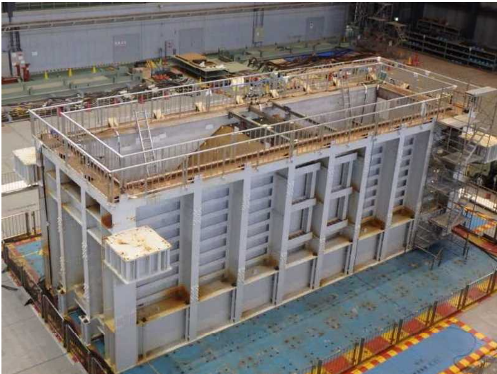
写真 3-2 試験体の施工完了後、震動台の上に設置した土槽の全景
