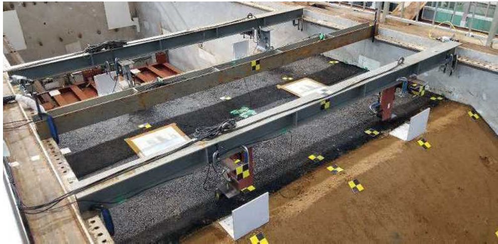
(a) 天端の変位計設置様子
