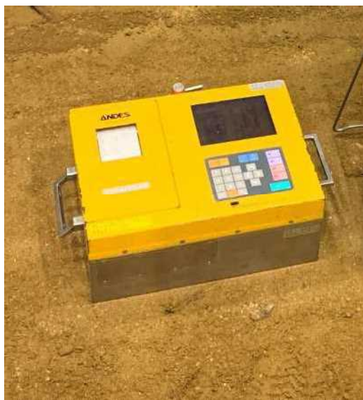
写真 3-7 RI 計器による締固め度測定
