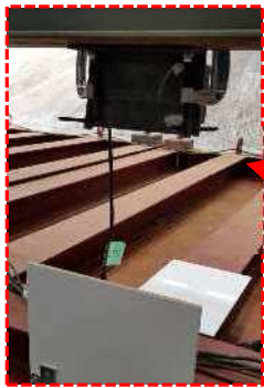
(b) 1 段タイプの変位計設置様子
