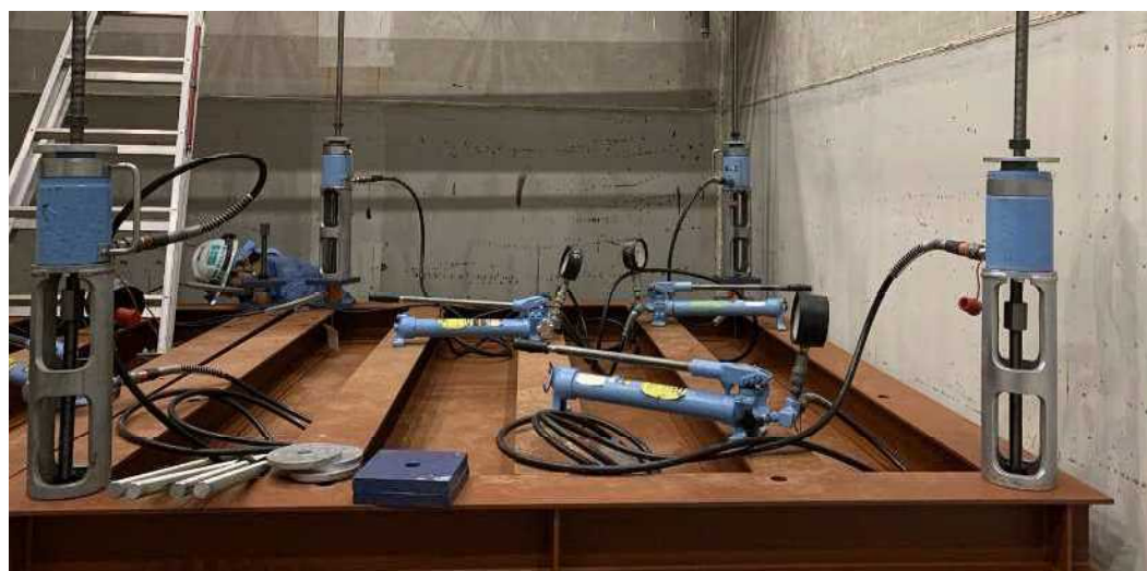
写真 3-11 プレストレス載荷の様子
