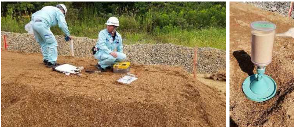
写真 3-4 RI 計器及び砂置換法の実施様子
