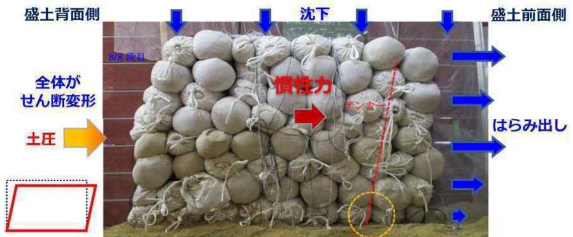
写真 2-3 大型振動台を用いた加振実験における法先補強した盛土の土のう構造体(プレストレス 50 \text{ kN/m}^2 ) (加振後にせん断変形が発生) 6)
