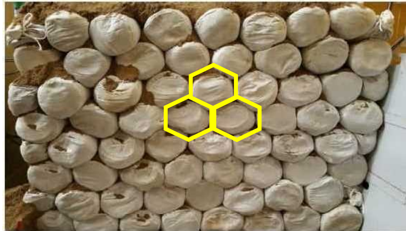
写真 2-2 大型振動台を用いた加振実験における法先補強した盛土(Case2)の土のう構造体(プレストレス 75 \text{ kN/m}^2 ) (加振後もハニカム構造を維持) 5)
