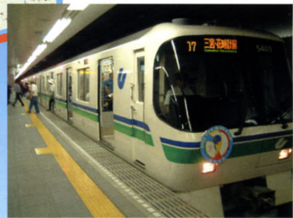
安全で人にやさしい 鉄輪式リニアモーターの 地下鉄海岸線
