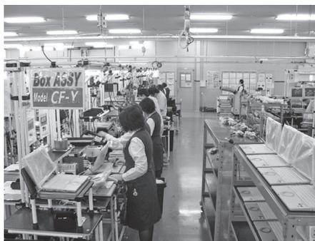
写真 64 神戸工場のノートパソコン完成組み立て工程（パナソニック コネクト提供）
