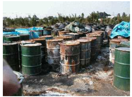
放置されたドラム缶 (腐食が進み危険な状態)
