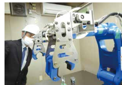
スマートものづくりセンター神戸 の指導により企業へ導入された パイプ搬送用ロボット
