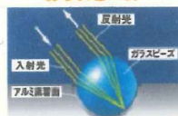
入射光は、ガラスビーズの表面を通過するとき屈折し、裏側のアルミ蒸着面で反射して、再び表面を通過するとき屈折して光源に戻ります。
