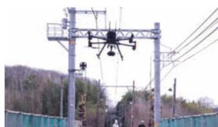
線路直上でのドローン自動飛行
