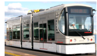
低床電池駆動LRV (ライトレール車両)
