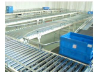
コンベア駆動用小型モーターローラ
