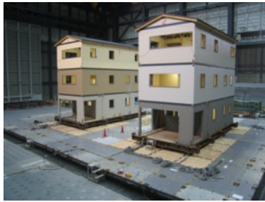
さまざまな構造物の破壊実験を行う大型振動台
