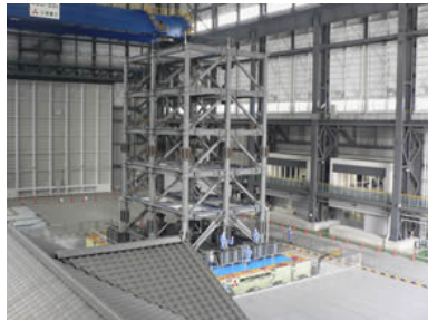
さまざまな構造物の破壊実験を行う大型振動台
