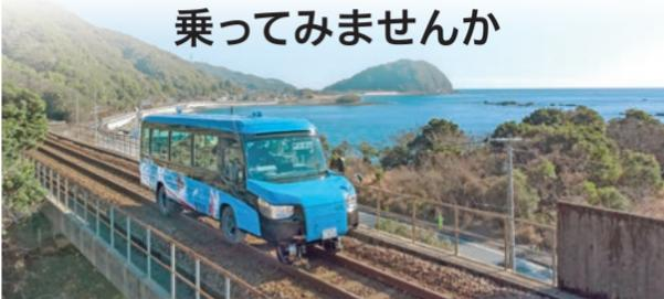
徳島県と高知県を結ぶ阿佐海岸鉄道が昨年12月に世界で初めて本格営業運行を開始したDMV(デュアルモード・ビークル)は、線路と道路の両方をシームレスに走行する次世代の乗り物。約15秒で鉄道モードとバスモードを切り替えるモードチェンジャー、車窓に広がる美しい海岸線は必見です。ぜひ体感してください。
