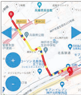
経路上にある坂が青(通行可能)、黄(通行困難)、赤(通行不可)の3段階で表示されます。
