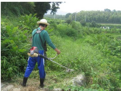
注意配分数 5 (刈払機草刈) 対象：ハンドルを持つ両手・ アクセル・刃・ 刃の周囲のこれから刈る草・ 足元
