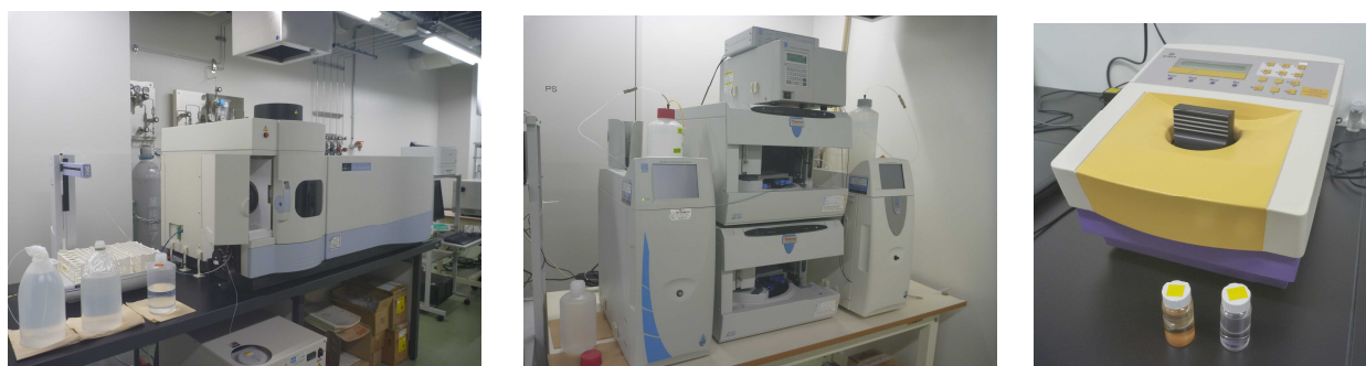
図2 分析機器(左:ICP-AES、中央:IC、右:ポータブル液シン)
