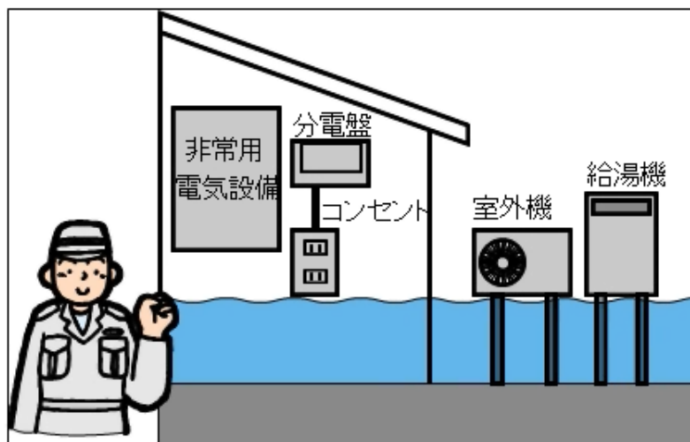
図 7-10 電気設備の浸水対策
