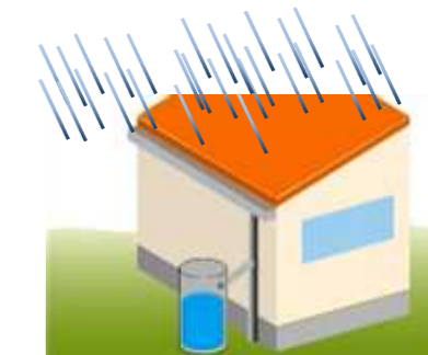
屋根に降った雨水を貯留
