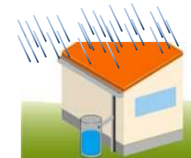
屋根に降った雨水を貯留
