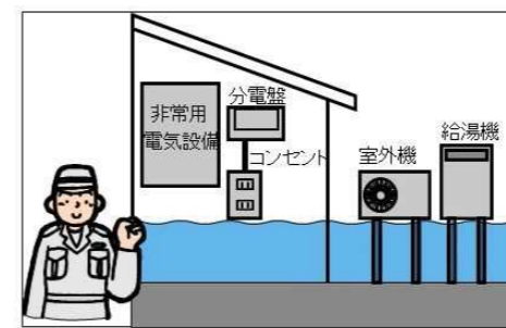
図7-10 電気設備の浸水対策
