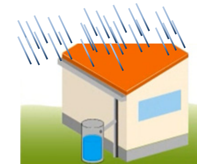
屋根に降った雨水を貯留
