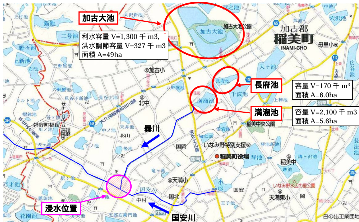
洪水調節機能をもたせた洪水吐を設置 (加古川流域土地改良事務所)
