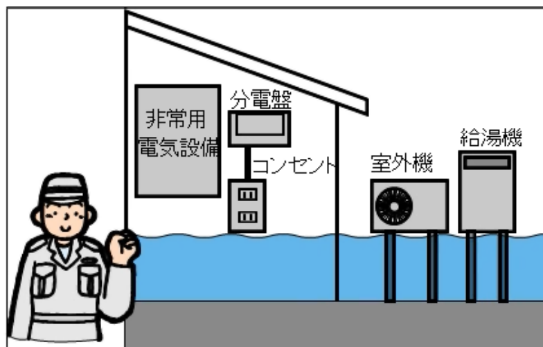
電気設備の浸水対策
