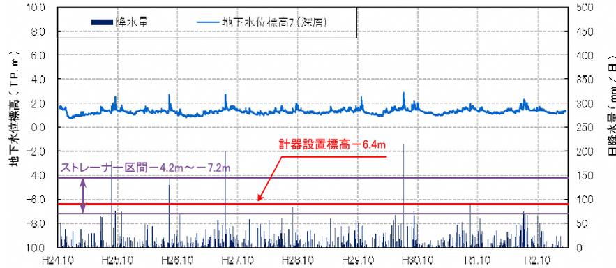
・地下水位は、年間を通じて標高1.0m前後の水位であるが、降雨の影響を敏感に受けて変動する。
