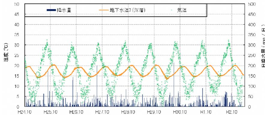
・水温は、13~21°Cの幅で変動する。他の深層観測井と比較して変動幅が大きい。周期性をもっており、気温と比較して、概ね3ヶ月ピークがずれている。
