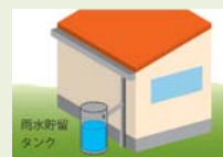
雨水貯留タンク
