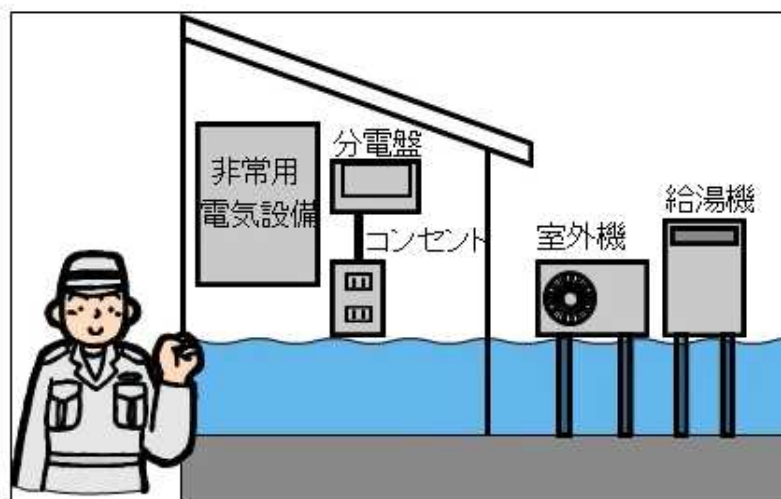
図 7-15 電気設備の浸水対策
