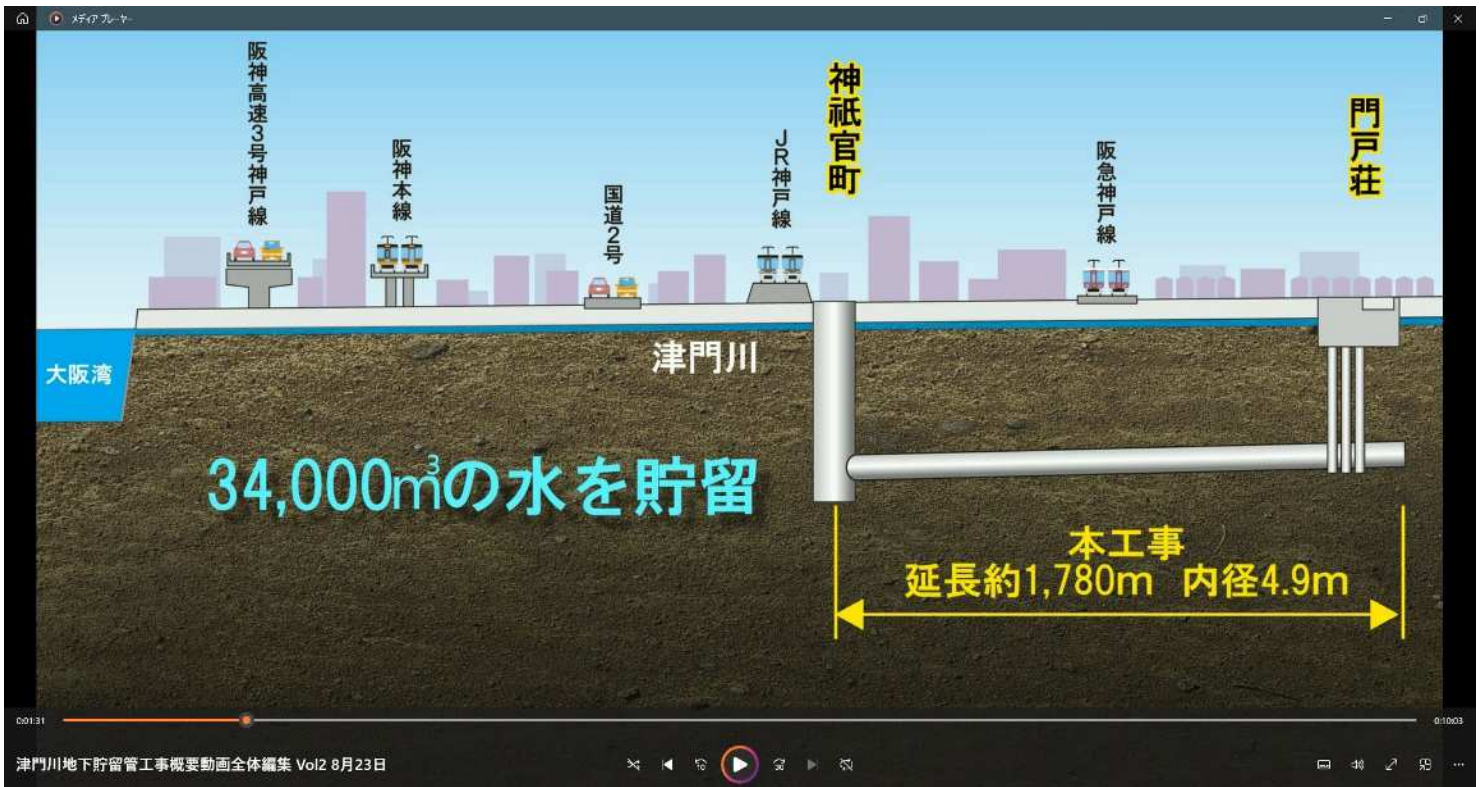
津門川地下貯留管工事概要
