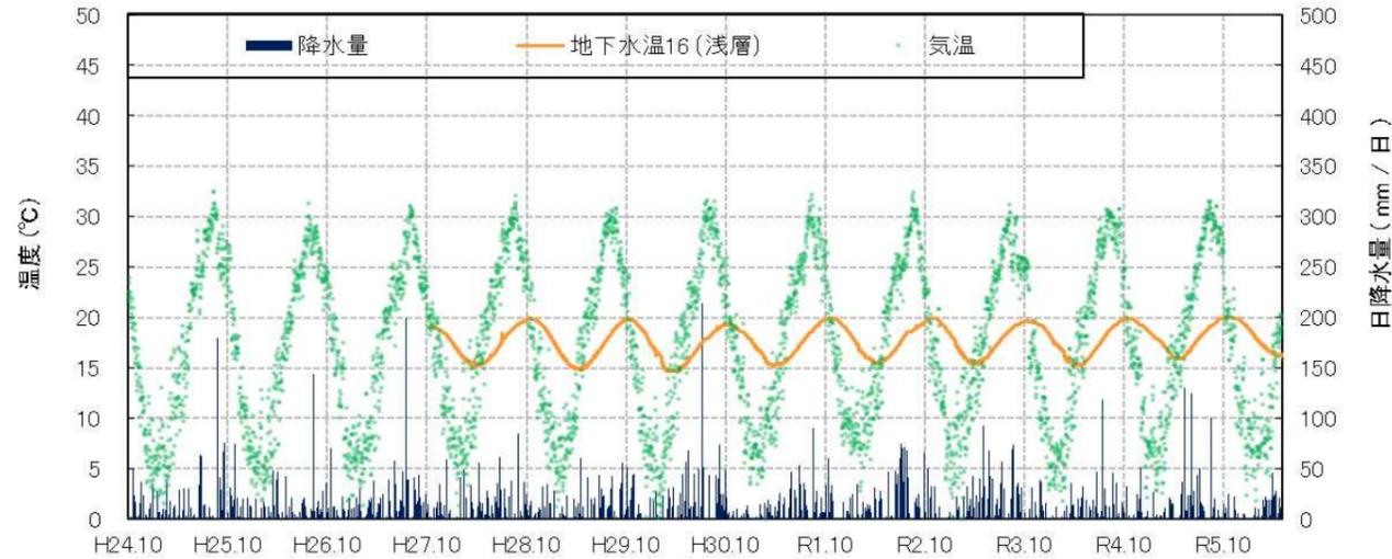
・標高-3.9m付近の水温は、14℃～20℃の幅で変動する。周期性をもっており、気温と比較して概ね2～3ヵ月ピークがずれている。
