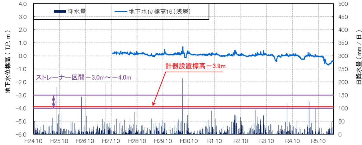
・地下水位は、標高0.1m程度である。令和3年12月～令和4年2月、令和5年1月～3月、令和5年12月から河川工事による影響で水位低下がみられる。令和6年2月下旬から回復傾向にある。
