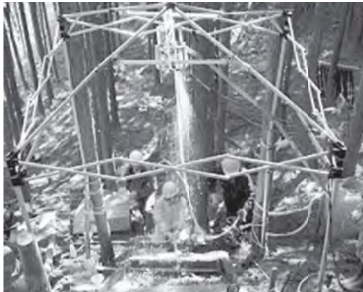
図-11 正確な浸透能を測定できる方法の一つとして提案された方法（恩田裕一氏撮影）
