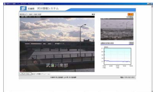
写真 4. 1. 3 河川監視カメラ画像の配信
