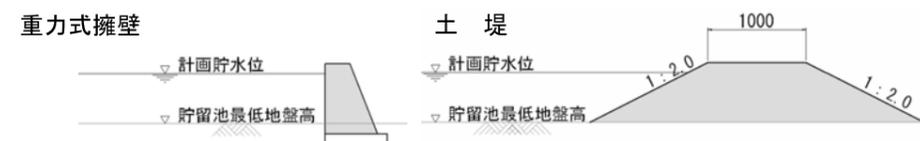
図-5 築堤の構造
