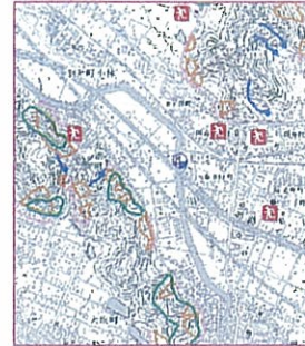
※CGハザードマップで土砂災害危険箇所を示した図です。
