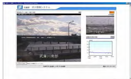
写真 4. 1. 3 河川監視カメラ画像の配信
