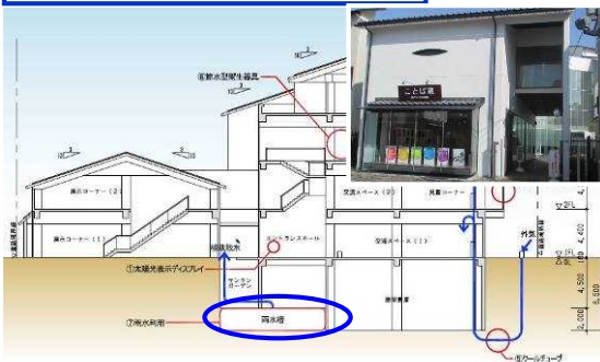
【地下貯留】伊丹市立図書館
