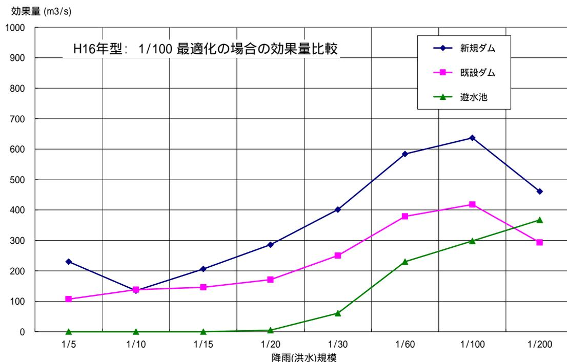
3 . H16 年型降雨： 1/20 最適化のときの新規ダム，既設ダム，遊水池の効果量比較
