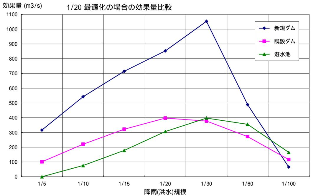
4 . H16 年型降雨： 1/30 最適化のときの新規ダム，既設ダム，遊水池の効果量比較
