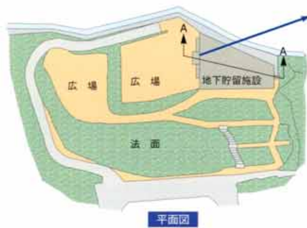
地下貯留槽がいっぱいになると中央の流出口から地上の公園部に貯留される
