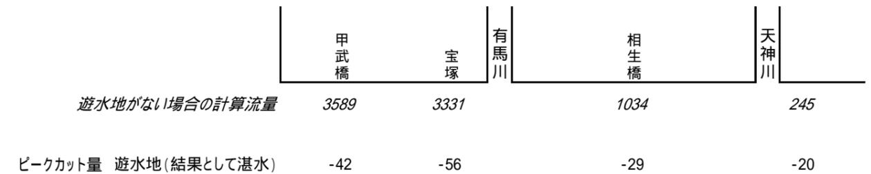
”遊水地がない場合の計算流量”は青野ダム有りの場合の数値であり、各地点でのピーク流量を示している。ピークカット量は”遊水地がない場合の計算流量”から遊水地により洪水調節された効果量を示している。
