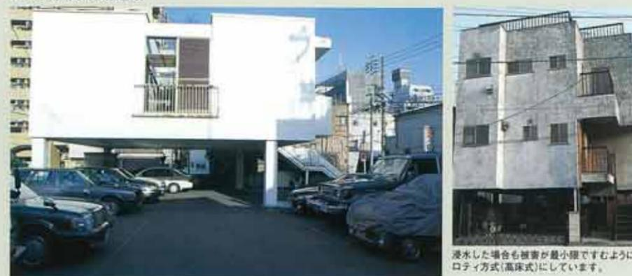
浸水した場合も被害が最小限ですむようにピロティ方式(高床式)にしています。
