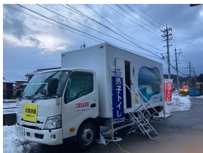
自走式水洗トイレカー（南あわじ市）
