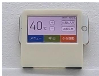
スマートフォンを組み込んだリモコン試作品
