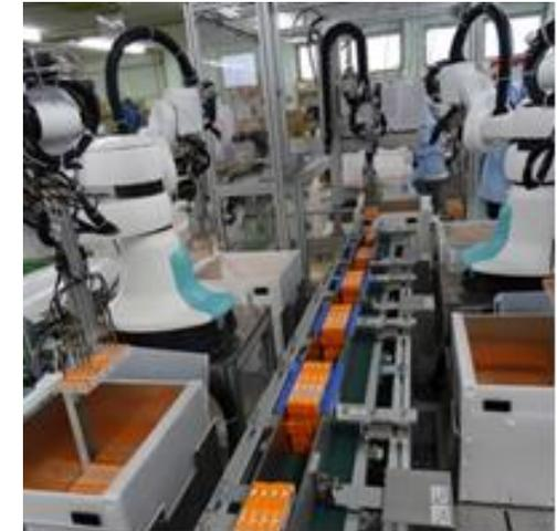
ロボットによる箱詰め作業
