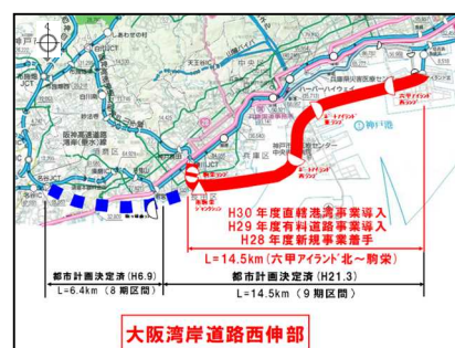
大阪湾岸道路西伸部の整備状況
