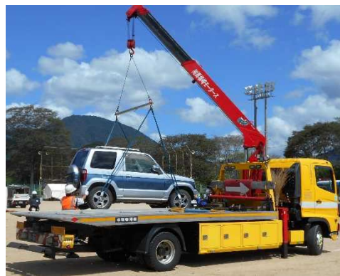
道路啓開訓練（放置車両レッカー移動）
